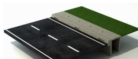
Зураг 10.9. Автозамын борооны ус зайлуулах хажуугийн ус оролттой лоток
