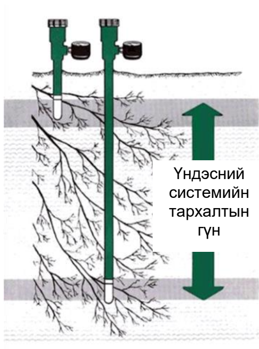
Зураг 8.3. Хөрсний чийг хэмжигч тензиометр
