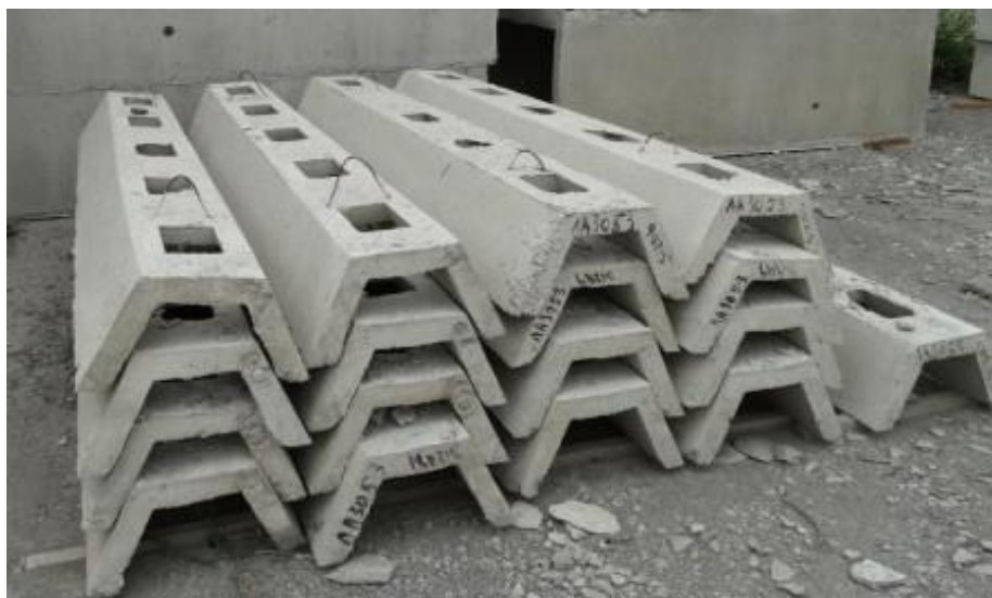
Зураг 10.2. Бетонон трапец хэлбэрийн онгоцон сувгийн хэв
