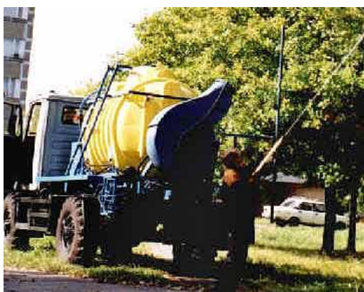
Зураг 6.11. Зориулалтын машинд суурилуулсан сэнсэн шүршигч
