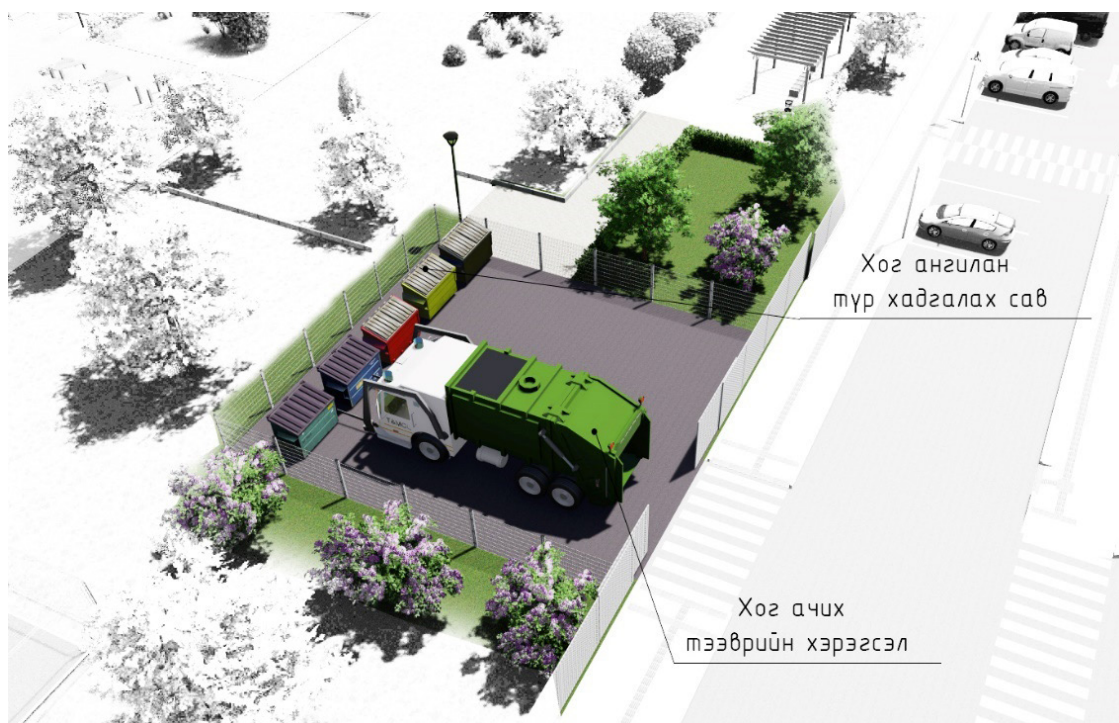
Зураг 21.1. Хог хаягдал цуглуулах цэг
