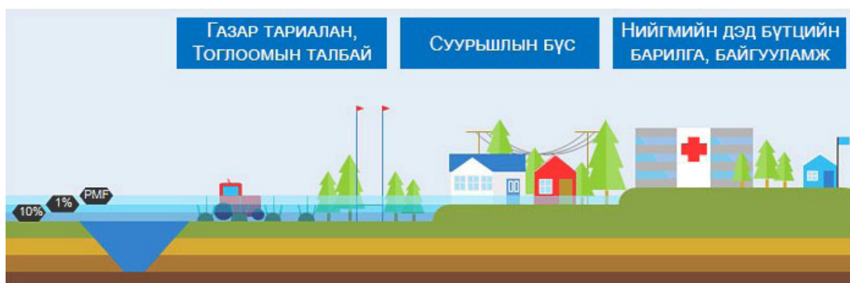
Зураг 3. Үерээс хамгаалах борооны ус зайлуулах байгууламжийн төлөвлөлт
