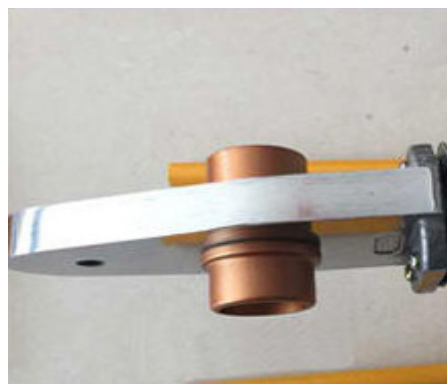
Зураг 7.7. Авцалдуулан наах элементтэй холбогч хэрэгслээр тулгаж ширээх, хоолойны амсрын црмэгийг халаах.
